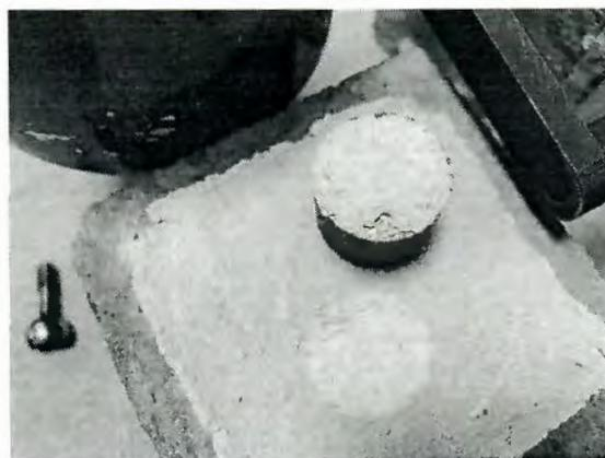
Фото 2. Характер отрыва когезионный по телу образца
